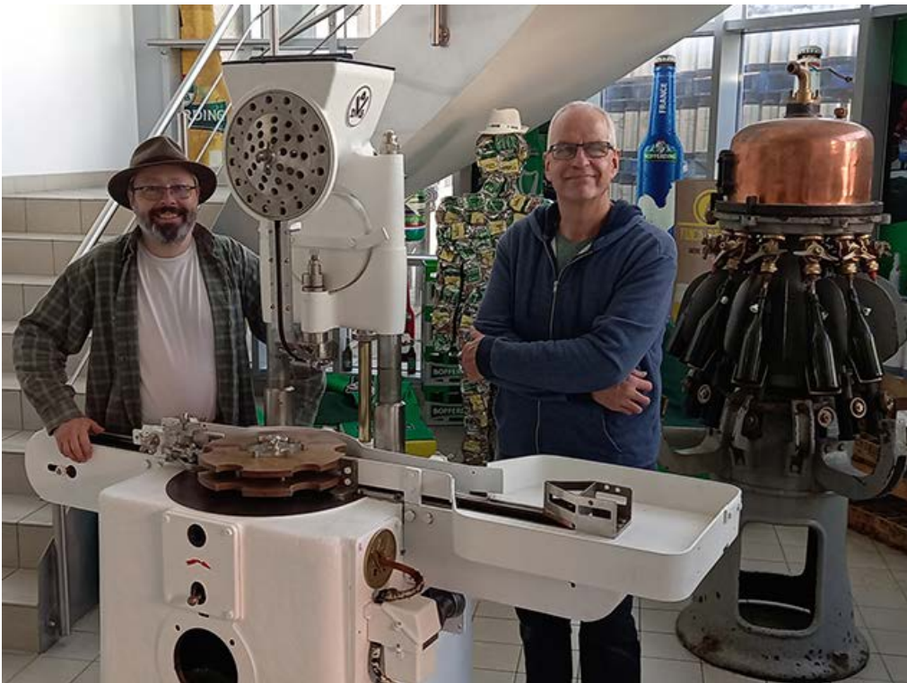
Zwei Maschinen (im Vordergrund eine Kapselmaschine und im Hintergrund ein Rotationsabfüller), die von Yves Claude und Romain Bintener zwischen 2021 und 2023 renoviert wurden.
