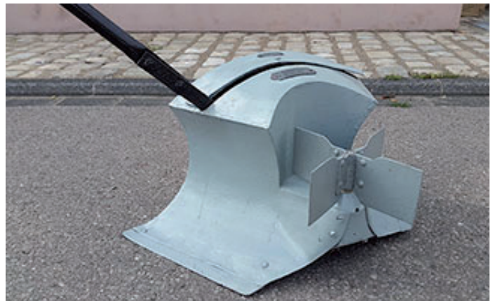
Vue en détail du retourneur de malt de la brasserie de Diekirch.
