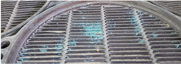
Die Filterplatten aus Messing vor dem Sandstrahlen. Baumwollenscheiben wurden in die Vertiefung gelegt.
