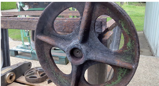
Eines der Räder, welches sich nicht abnehmen ließ. Es wurde also von Paul Claude erhitzt, bis es rot glühte und sich endlich abnehmen ließ.
