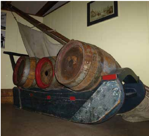
Oben: eine sehr seltene Anlage zum Pichen der Holzfässer ...
