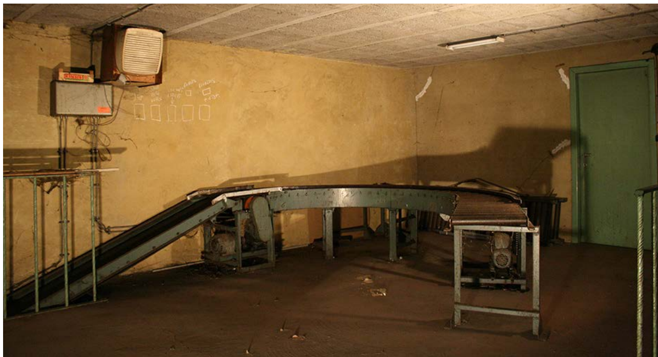
Les casiers avec les bouteilles lavées étaient placés sur un tapis roulant qui les emmenait jusqu'au premier étage, où ils étaient entreposés.
